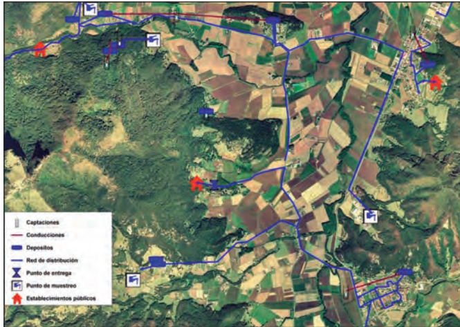
Figura 100. Girona. Infraestructura de abastecimiento de agua
